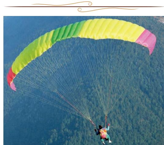
В 70-е годы появились парашюты принципиально нового класса: планирующие оболочки, так называемые «крылья». Принцип действия «крыла» отличается от принципа зонтика: за счёт разности площадей верхней и нижней оболочек поток обтекает парашют с разной скоростью сверху и снизу, из-за чего возникает подъёмная сила; пока парашют движется вперёд — он сам себя держит на весу (так же работает и крыло самолёта).
