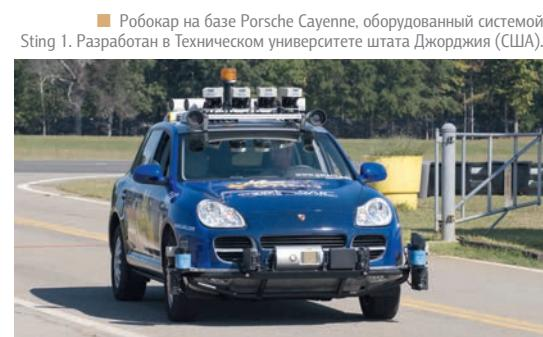
■ Робокар на базе Porsche Cayenne, оборудованный системой Sting 1. Разработан в Техническом университете штата Джорджия (США).
